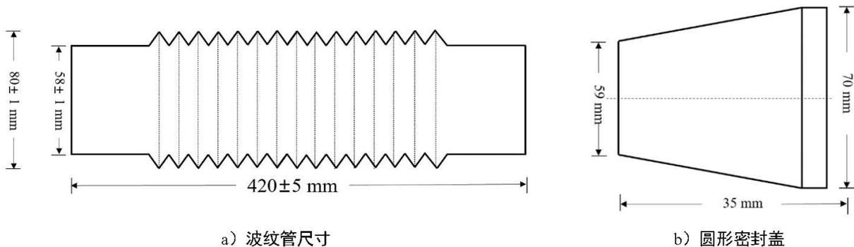
图 C.1 超高性能混凝土早龄期收缩模具尺寸
